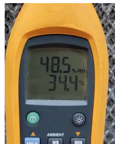
รูปวัดสภาวะอากาศเข้าสู่ชุดเครื่องปรับอากาศสำหรับจ่ายลมเข้าห้อง เครื่อง 2
