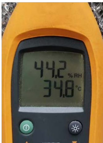
รูปวัดสภาวะอากาศเข้าสู่ชุดเครื่องปรับอากาศสำหรับจ่ายลมเข้าห้อง เครื่อง 1
