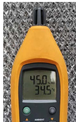
รูปวัดสภาวะอากาศเข้าสู่ชุดเครื่องปรับอากาศสำหรับจ่ายลมเข้าห้อง เครื่อง 2
