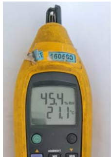
รูปวัดสถานะอากาศออกจาก เครื่องปรับอากาศ
