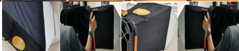
รูปวัดอัตราการไหลเชิงปริมาตรบริเวณช่องระบายอากาศออกจากห้อง เครื่อง 1
