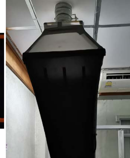
รูปวัดอัตราการไหลเชิงปริมาตรบริเวณช่องจ่ายอากาศเข้าห้อง
