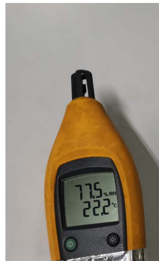
รูปวัดสภาวะอากาศภายในห้อง
