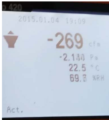
รูปวัดอัตราการไหลเชิงปริมาตรบริเวณช่องระบายอากาศออกจากห้อง
