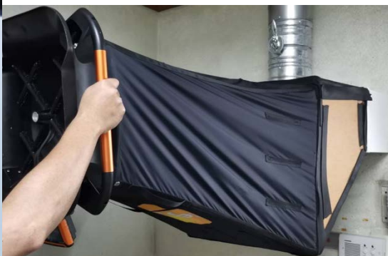
รูปวัดอัตราการไหลเชิงปริมาตรบริเวณช่องระบายอากาศออกจากห้อง
