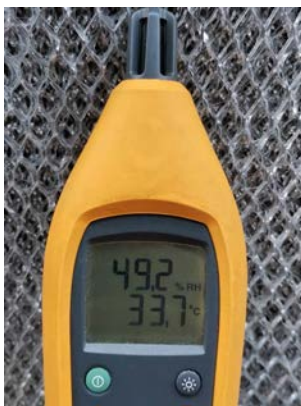
รูปวัดสภาวะอากาศเข้าสู่ชุดเครื่องปรับอากาศสำหรับจ่ายลมเข้าห้อง
