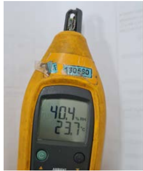
รูปวัดสถานะอากาศออกจาก เครื่องปรับอากาศสำหรับจ่ายลมเข้าห้อง
